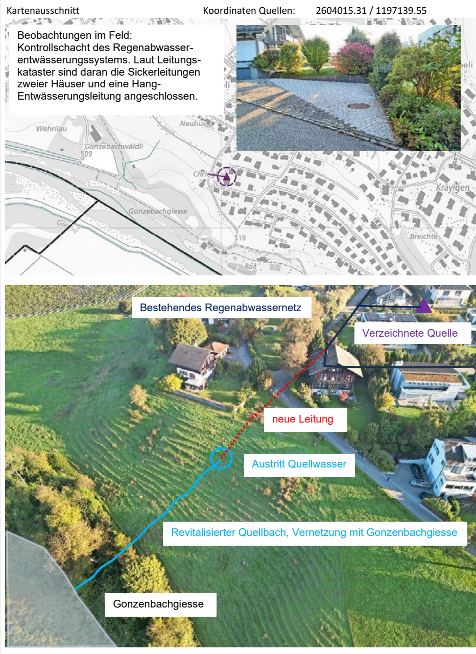
Fig. 5 Für die «vergessenen Quellen» wurde das Revitalisierungspotenzial mittels Informationen der Gemeinde und einer Begehung vor Ort abgeschätzt.
