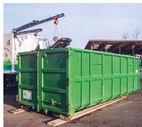
Bis zum Neubau des Schlammwässerungsgebäudes wurde der Klärschlamm mit mobilen Aggregaten entwässert.
